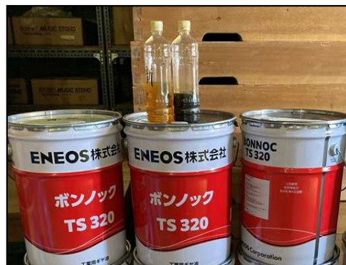
ギヤオイル 交換前・交換後 (左:取替える油 右:取除いた油)
